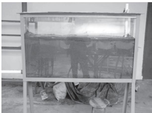
Gambar 1. Kotak percobaan aliran dalam tanah.
