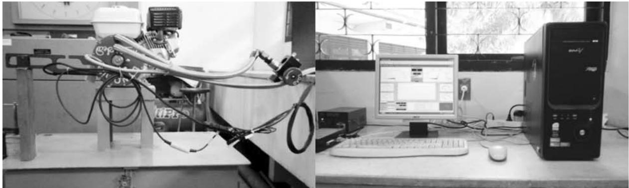
Gambar 1. Pengaturan pengujian kinerja konverter dengan dinamometer
