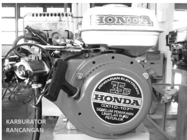
Gambar 5. Konverter biogas yang dipasang pada motor bensin
