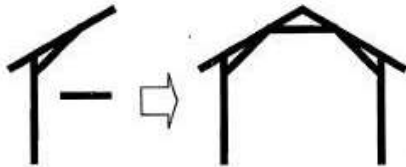
Gambar 3. Model Komponen atap rumah tahan gempa
