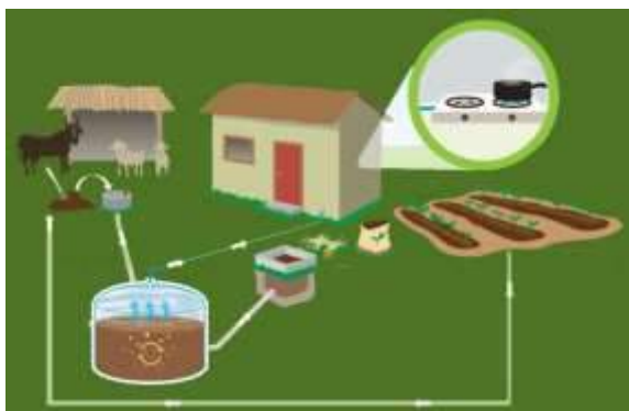
Fig. 1 Skema pengolahan sampah menjadi sumber energi ramah lingkungan. Pengolahan sampah sisa manusia (atas). Pengolahan sampah sisa ternak (bawah).
