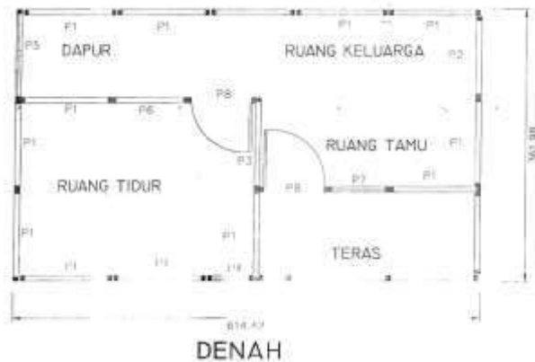
Gambar 6. Denah Rumah Contoh Tahan Gempa Pre-Pabrikasi
